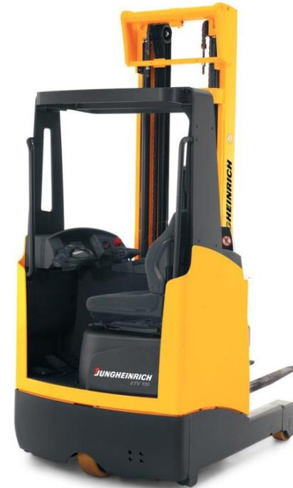
Chariot élévateur, muni d'un mât frontal avec légère inclinaison, pouvant lever des charges jusqu'à environ 12m pour un usage principalement magasinier. Le conducteur est perpendiculaire au sens de la marche.
