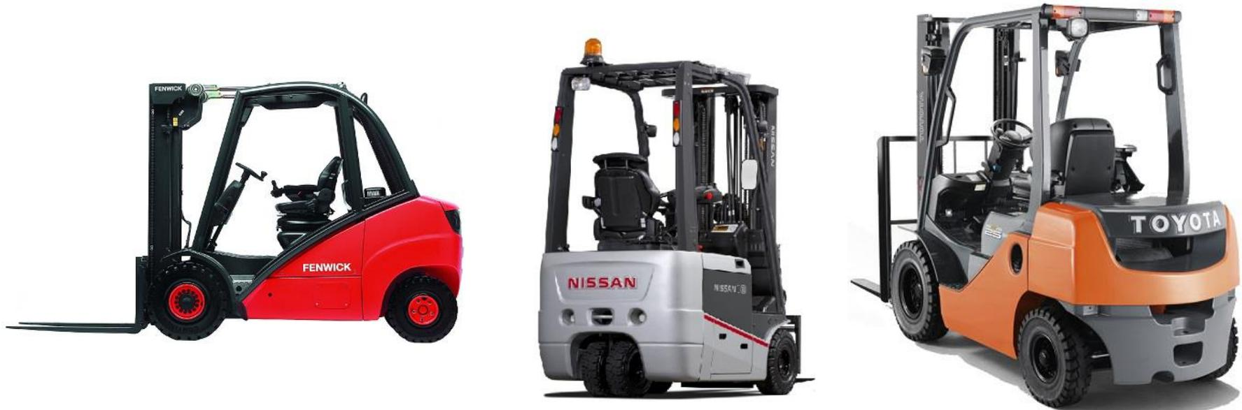
Chariot élévateur, muni d'un mât frontal inclinable, pouvant lever des charges jusqu'à environ 7m pour un usage principalement magasinier.
