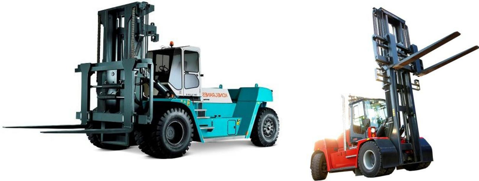
Chariot élévateur, muni d'un mât frontal inclinable, pouvant lever des charges jusqu'à environ 10m pour un usage principalement extérieur (ports, scieries, papeteries).
